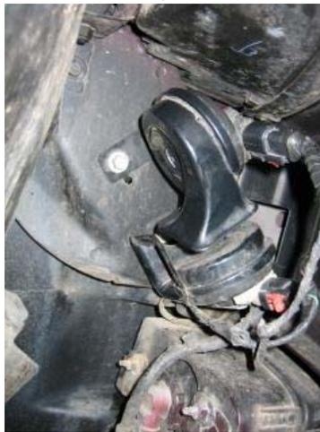
L'avertisseur remonté. Ensuite plus qu'à remettre en place le cache, l'agrafe et les 3 vis et bien-sûr, remettre la roue !
