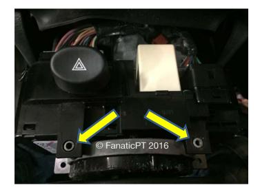
Soulever le bloc, il vient très facilement et débrancher les deux prises. Ensuite, à l'aide du torx n° 10 dévisser les deux vis qui tiennent le comodo des essuies-glace et remettre celui-ci sur le nouveau.
