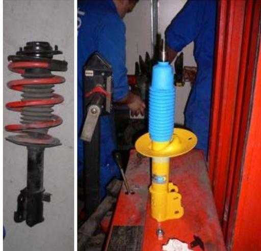
L'amortisseur, une fois déposé, il vous faut le présenter dans un appareil qui vous permet de compresser le ressort, ceci afin de pouvoir déposer l'écrou qui maintient l'ensemble amortisseur-ressort-coupelle en toute sécurité : **Etape Dangereuse au plus haut point**. Une fois l'ensemble déposé il faut représenter le ressort et les nouvelles coupelles sur l'amortisseur neuf toujours grâce au compresseur. Vérifiez que l'ensemble est correctement maintenu avant de relâcher votre ressort.
