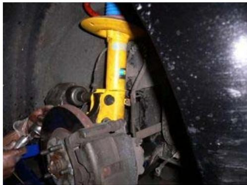
Ca y est, il est en place. On peut remonter la .... ah ben non j'avais oublié, on doit aussi changer le bras inférieur au silent-bloc légèrement usé
