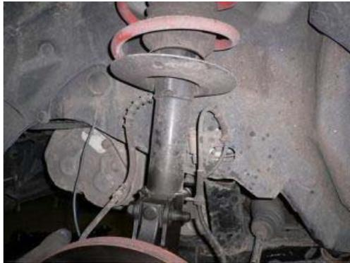
Dans un premier temps, dévissez les écrous de maintien sur le haut de l'amortisseur et après faite de même avec les vis et écrou sur l'amortisseur.
