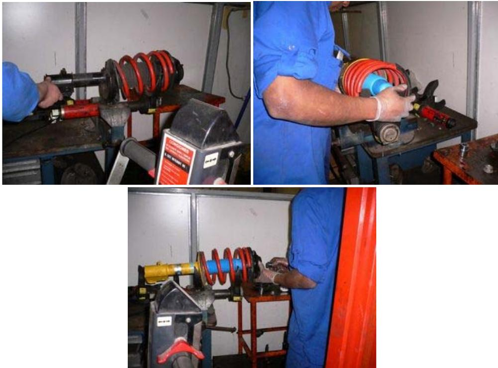
Pensez à récupérer les différents accessoires de l'ancien amortisseur pour les mettre sur le nouveau. Ici il s'agit d'un écrou pour le maintien des câbles de frein.
