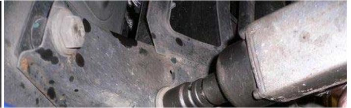
Il vous suffit, armé de votre clé à choc, entre autres, de tomber tous les écrous et vis qui le maintienne tout en faisant très attention au sens de votre démontage pour remettre le nouveau en place. Préférez être 2 pour cette opération aussi car les sortir de leur emplacement est mal aisé. De plus du côté passager, il faut démonter un support moteur pour avoir accès à une des vis de maintien.
